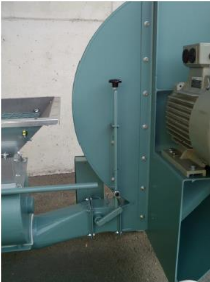
Figuur 2: Bedieningsmechanisme van de regelschoep
